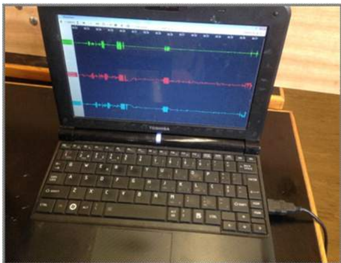
Figura 9 – Registo das ondas sísmicas geradas pela mesa sísmica no modelo misto.
