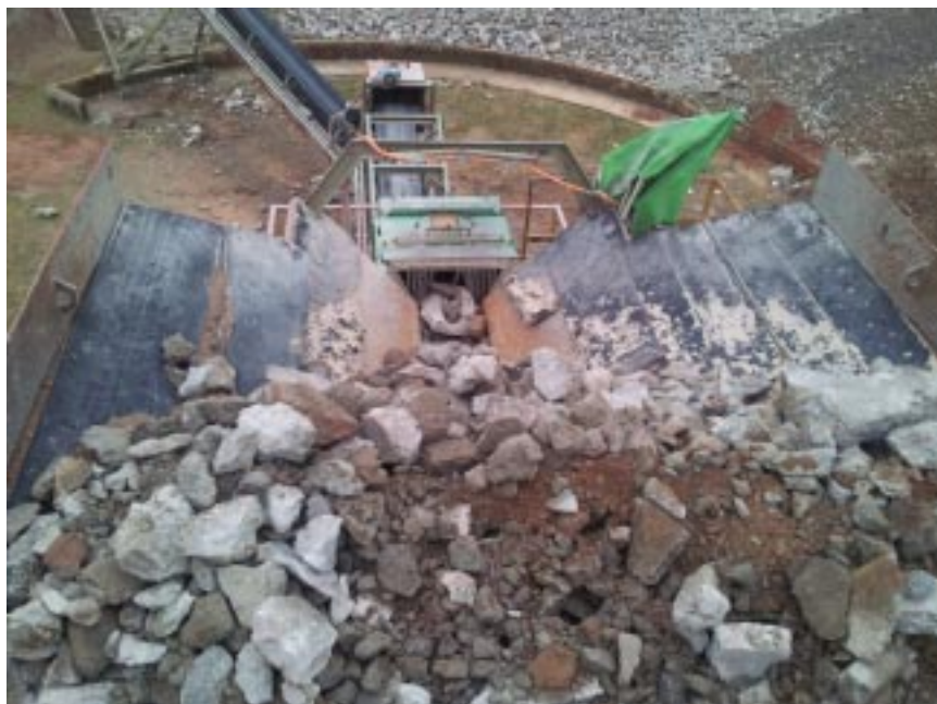
Figura 4. Resíduo depositado no alimentador vibratório. Fonte: os autores.
