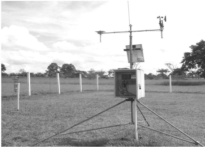
Figura 1. Detalhe da estação meteorológica instalada no CUML.
