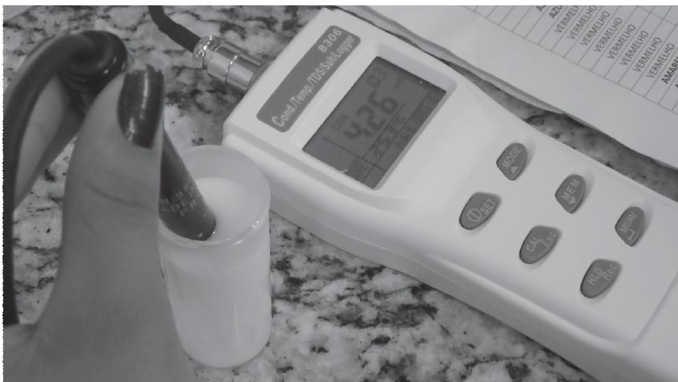
(Painel do aparelho AK83 CONDUTIVÍMETRO DIGITAL PORTÁTIL)
